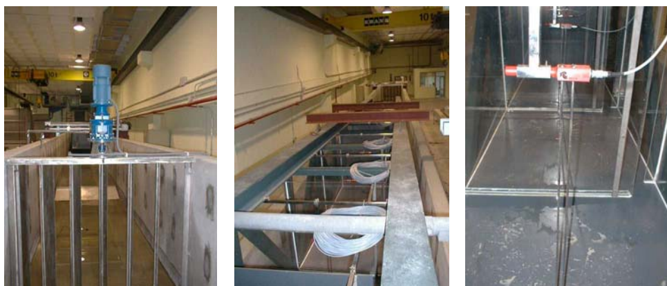
Figura 7.1.6. Canal de hidráulica fluvial. Vistas desde aguas abajo, aguas arriba y detalle de uno del ensayo de escalas de hendidura vertical
